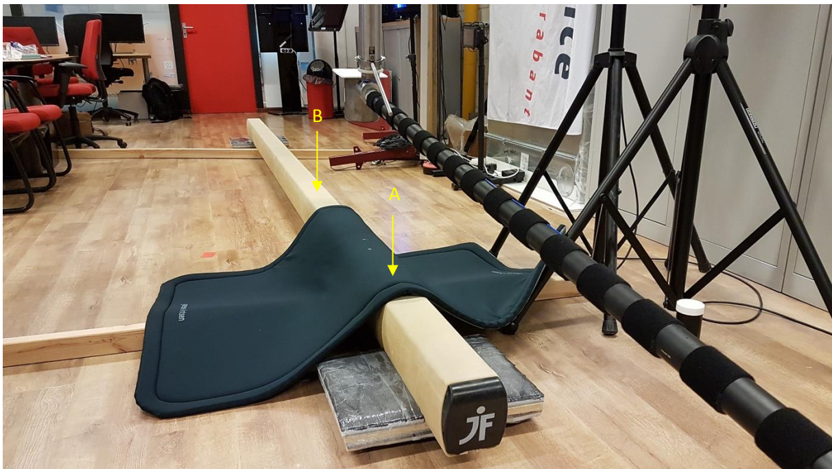
Figuur 1: Visuele weergave van de testopstelling met de Soft Touch balk. Aangegeven zijn de twee meetlocaties: meetlocatie A (op indicatorpunt 125 van de balk) en locatie B (midden van de balk).
